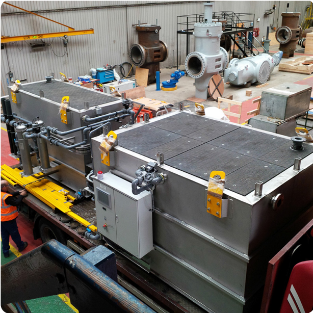
Los dos sistemas fueron equipados con paneles de cubierta Fibrelite para tener acceso desde la parte superior
